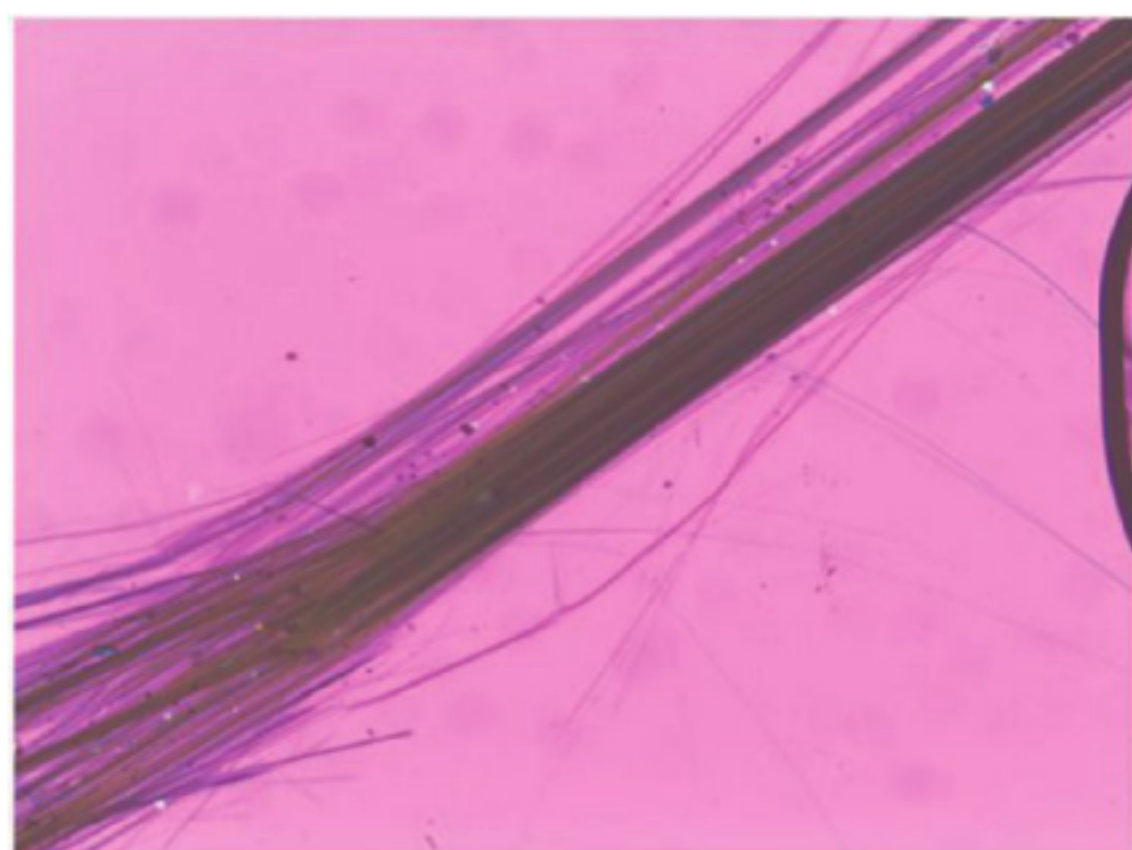
图 B.19 铁石棉在 n^{25\text{°C}} = 1.680 的浸油中的色散染色图(纤维平行于起偏器的偏振化方向)
