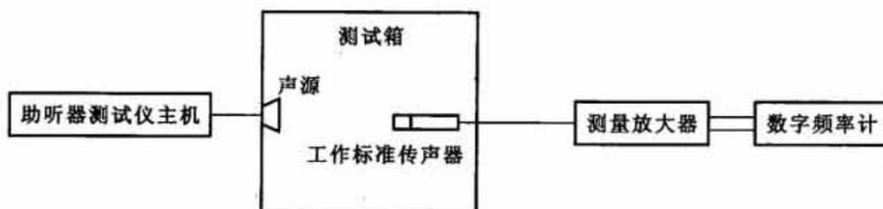
图3 声源频率准确度的校准装置示意图
