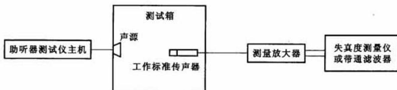
图4 声源声信号总谐波失真的校准装置示意图
