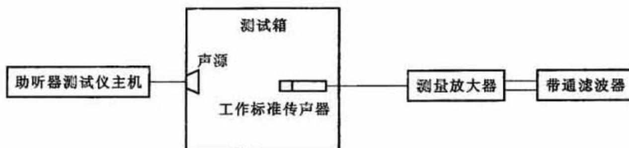
图 1 替代法参考声压级误差的测量装置示意图
