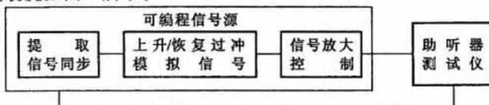
图 7 上升/恢复时间测量装置示意图
