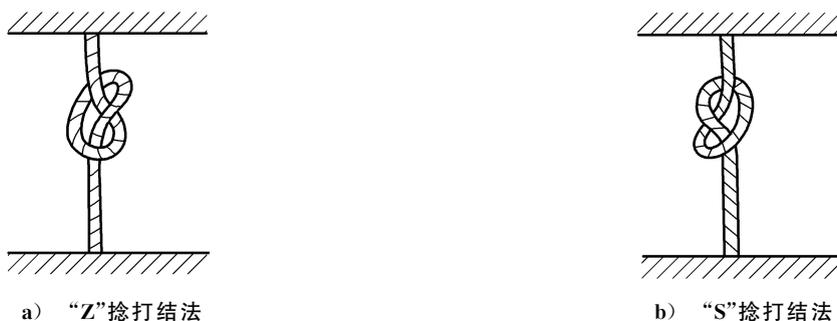
图 5 化纤长丝打结强力试验
