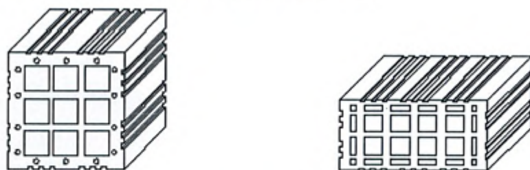
图 B.1 空心砖孔洞排列示意图
