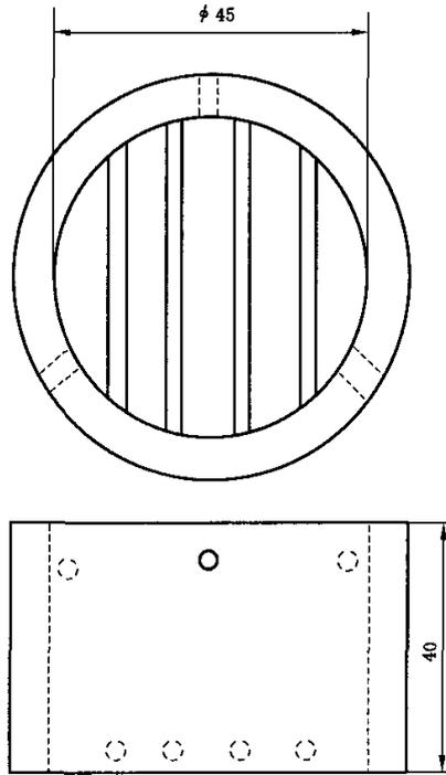
图 A.1 实验盒结构与尺寸示意图
