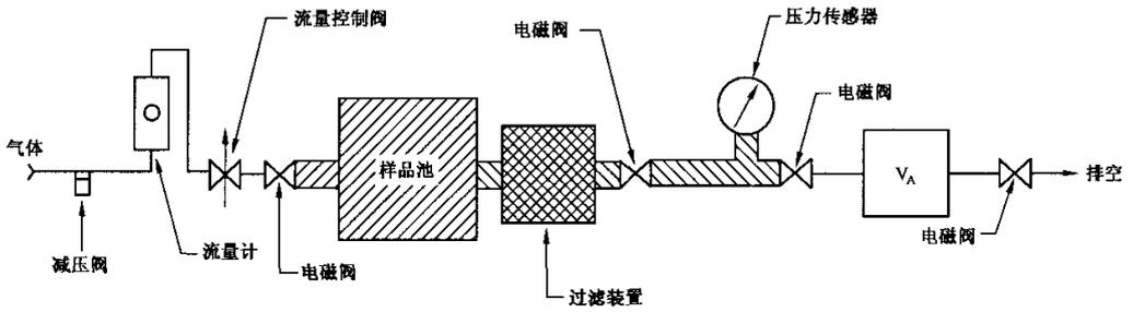
图 A.4 真密度仪结构示意图
