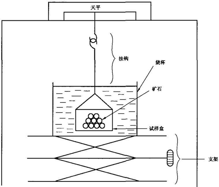
图 A.3 水中测定质量的示意图
