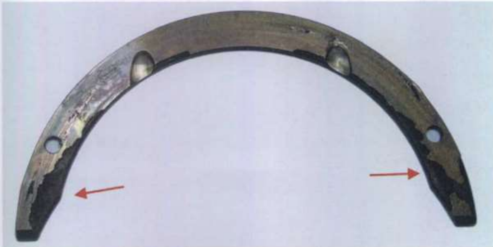
材料:钢/铜铅合金,止推垫圈表面合金局部剥落
