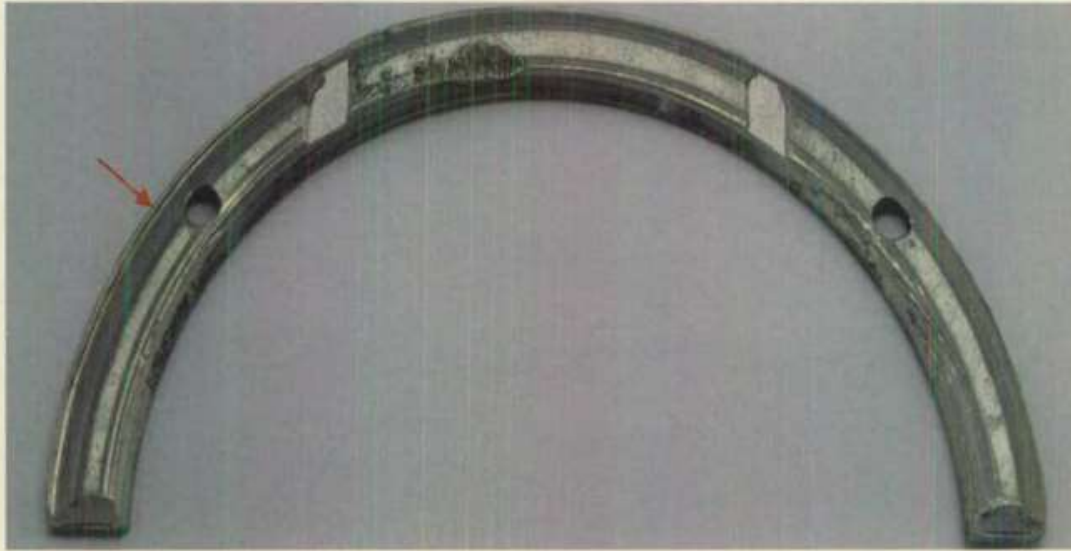
材料:钢/铝锡合金,止推垫圈止推面呈现周向犁沟状拉痕
