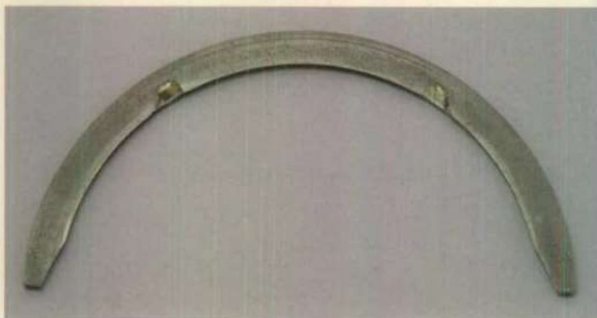
材料:钢/铝锡合金,止推垫圈合金表面呈现磨痕
