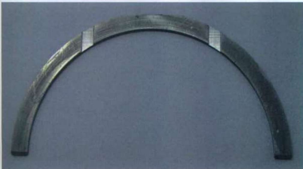
材料:钢/铝锡合金,止推垫圈止推面呈现抛光现象
