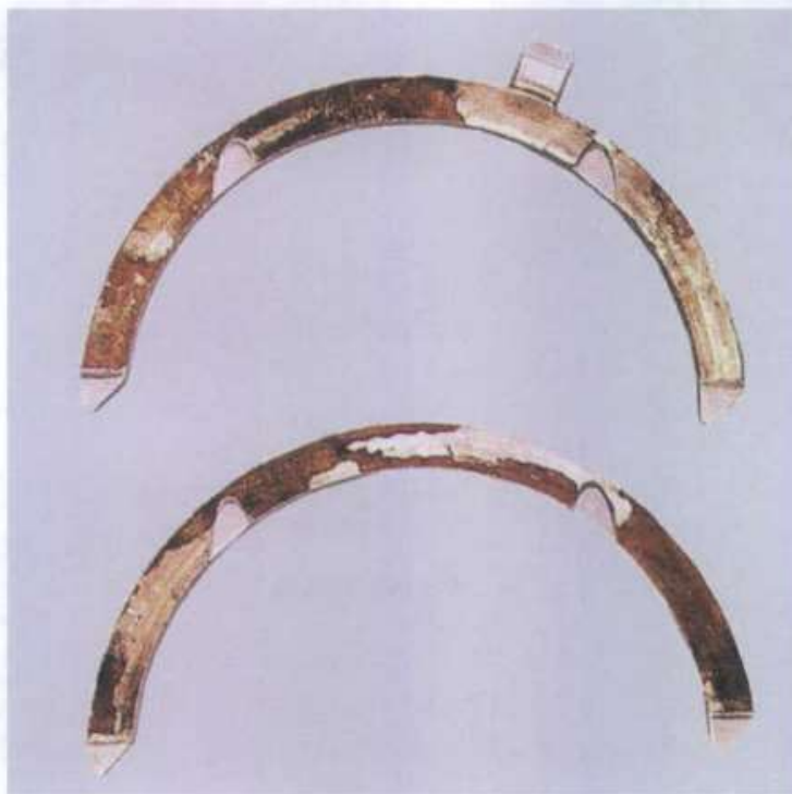
材料：钢/铜铅合金，止推垫圈表面呈现腐蚀痕迹
