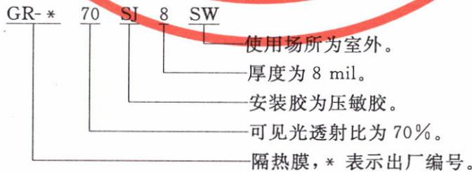
编号为 \*、具有 70% 可见光透射比、带有压敏安装胶、8 mil 室外用建筑玻璃隔热膜标记为: GR- \* 70 SJ 8 SW。
