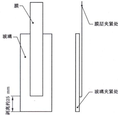
图 6 试样剥离示意图
