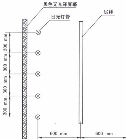
图 1 麻点、斑点、膜面划伤的测定示意图
