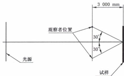
图 2 斑纹、皱褶、缺胶、气泡的测定示意图
